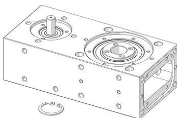
5. Montare le flange premi-cuscinetto sul lato motore, avvitando le viti che le fissano al corpo dell'attuatore applicando la coppia di serraggio riportata in tabella. Si consiglia di applicare frena filetti tipo Loctite 243
