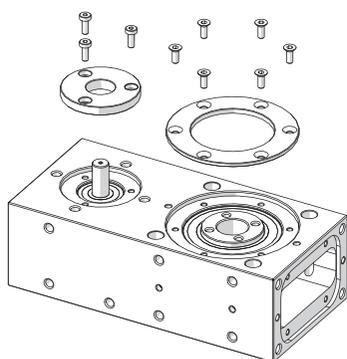
6. Montare la/e flangia/e rotante/i con le viti applicando la coppia di serraggio riportata in tabella. Si consiglia di applicare frena filetti tipo Loctite 243.
