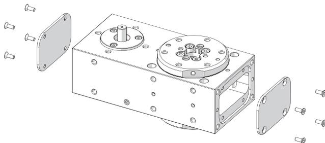
13. Rimontare il semi-giunto lato attuatore posizionandolo a circa 1 mm dal premi-cuscinetto, serrando la vite che lo chiude sull'albero del pignone. Fissare la piastra di collegamento all'attuatore e infine il motore.
