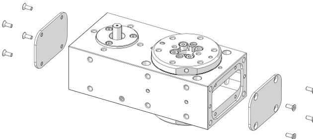
3. Smontare la flangia rotante svitando le 4 viti che la fissano alla puleggia condotta.
