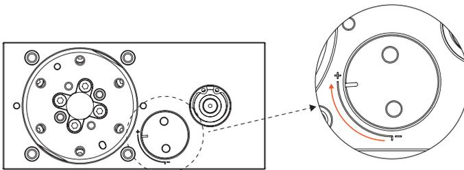
10. Verificare il funzionamento facendo ruotare la flangia rotante per almeno un giro, in entrambi i sensi, applicando all'albero del pignone la coppia massima riportata in tabella. La verifica è superata se la flangia rotante si muove in entrambi i sensi in maniera fluida e uniforme.
