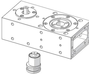
7. Rimuovere le flange premi-cuscinetto dal lato motore, svitando le viti che le fissano al corpo dell'attuatore.
