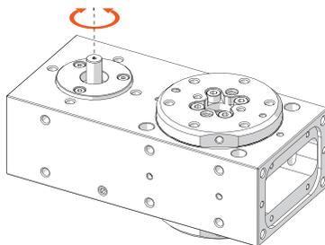
11. Avvitare il grano di fermo in battuta con la coppia di serraggio indicata di seguito in modo da assicurare la posizione del tenditore.
