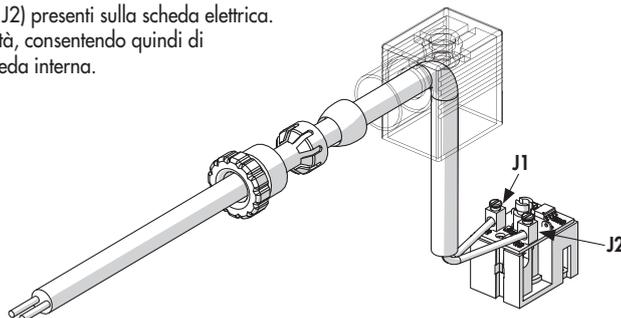
La scheda elettronica del connettore è dotata di un Led verde attivo quando la bobina è alimentata.
